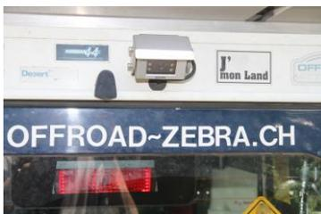
Nach vielen Tausend Kilometer Strapazen funktioniert das System immer noch tadellos. Allerdings wäre eine Reparatur fast unmöglich da die ganze Elektronik in Miniaturform im Rückwärtsspiegel integriert ist. Einzig bei Rüttelpisten ist das Gewicht des Rückwärtsspiegels etwas schwer, so dass sich dieser senkt. Da bleibt entweder das gelegentliche Nachjustieren oder eine Fixation des Original Rückwärtsspiegels.
