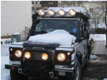
Bei der Montage habe ich versucht, möglichst Service freundlich vorzugehen. Die Scheinwerfer habe ich auf einer zusätzlichen Alu-Schiene untergebracht, so dass das gesamte Rack mit vier Schrauben abmontiert werden kann. Die Verkabelung habe ich über zwei spezielle (wasserdichte) 5-Pol Steckverbindungen zugeführt und auf der Rückseite sauber befestigt – auch um Wackelkontakten vorzubeugen.
